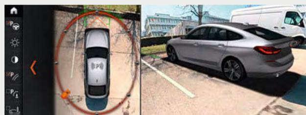
□ O sistema Surround View<sup>3</sup> facilita o estacionamento, tornando visível a área em redor do veículo com Top View, vista panorâmica com ativação automática e vista 3D.
