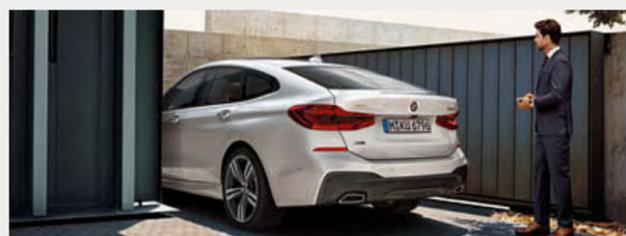
□ A função de estacionamento por controlo remoto<sup>4</sup> permite ao condutor sair do veículo antes de o estacionar através do controlo remoto, avançando ou recuando o veículo para sair de um lugar de estacionamento ou de uma garagem com pouco espaço. A função de estacionamento por controlo remoto é ativada pelo condutor no exterior do veículo através da chave BMW com display.
