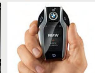
□ A chave BMW com display apresenta informações sobre o estado do veículo e permite controlar funções selecionadas através de um mostrador tátil integrado.
