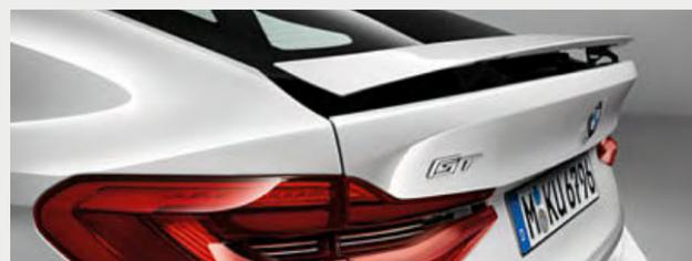
■ O spoiler traseiro ativo eleva-se automaticamente a velocidades superiores a 120 km/h e baixa quando a velocidade regressa aos 80 km/h para melhorar a estabilidade. Pode também ser ativado manualmente através de um botão na porta do condutor.
