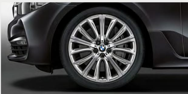
□ Jantes de liga leve BMW 628 de raios em V de 20" de duas tonalidades com pneus mistos Runflat, 8,5 J x 20 com pneus 245/40 R 20 à frente; 10 J x 20 com pneus 275/35 R 20 atrás.
