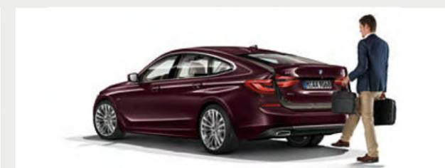
□ O sistema de acesso Comfort possibilita destrancar as quatro portas do veículo, incluindo a porta da bagageira, sem ter de se utilizar a chave. O equipamento opcional inclui abertura e fecho sem mãos da porta da bagageira com um rápido movimento com o pé sob o para-choques traseiro.
