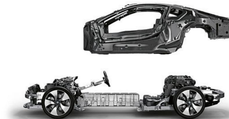
**MÓDULO DRIVE:** o módulo Drive do novo BMW i8 Roadster e do novo BMW i8 Coupé é construído em alumínio de baixo peso e inclui todos os componentes da suspensão: os elementos estruturais e de absorção de impacto, a cadeia cinemática e a bateria de íões de lítio de alta tensão.
