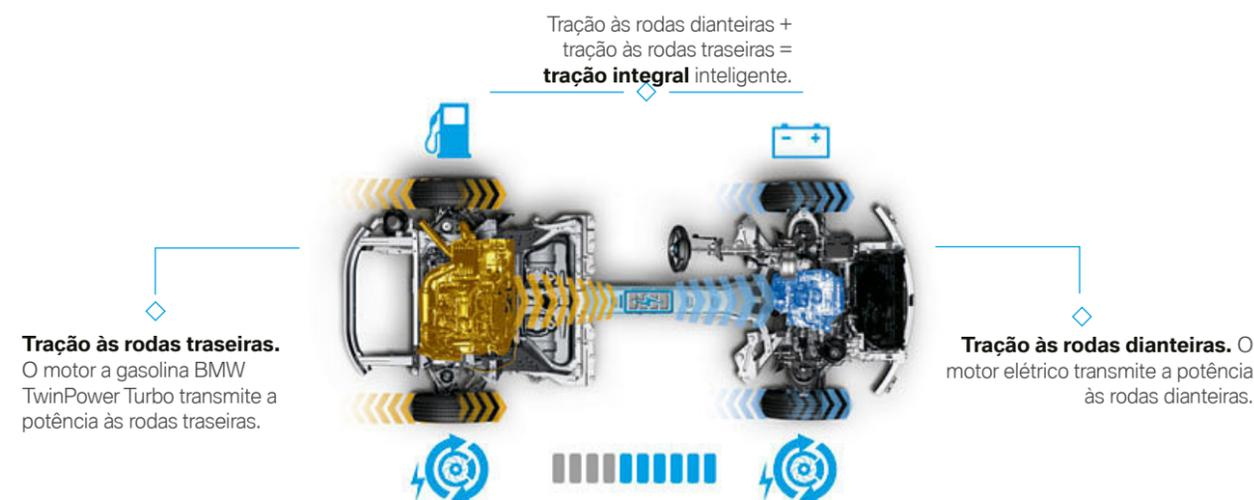
**RAÇÃO INTEGRAL PARA UMA TRACÇÃO TOTAL:** o novo BMW i8 Roadster e o novo BMW i8 Coupé combinam a aceleração de binário elevado do motor elétrico no eixo dianteiro com a potência do motor de combustão no eixo traseiro, que é transmitida à estrada de forma eficiente por uma transmissão de 6 velocidades Steptronic. Assim, o conceito permite que a configuração ideal da tração esteja disponível de acordo com a situação.
