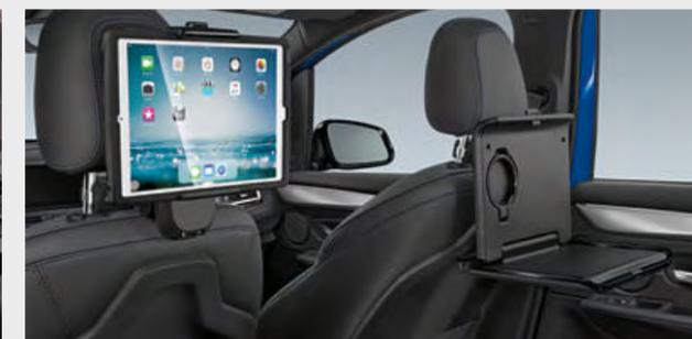
○ O suporte universal é ajustável em termos de tamanho e é encaixado no suporte base do sistema Travel & Comfort disponível em separado. Oferece suporte seguro para uma vasta gama de Tablets Apple e Samsung de 7" a 11" com capa de proteção para Tablets do sistema Travel & Comfort. Pode ser girado 360°, inclinado e fixado na posição pretendida.
