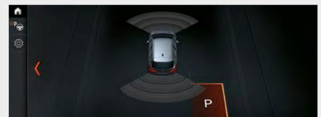
□ O assistente de estacionamento<sup>8</sup> facilita o estacionamento em paralelo. O sistema funciona através da medição de possíveis lugares de estacionamento quando passa por estes a baixa velocidade. Quando é encontrado um lugar de estacionamento adequado, o assistente de estacionamento assume o controlo da direção, enquanto o condutor é responsável pela seleção da mudança correta, bem como pelos pedais do acelerador e do travão.
