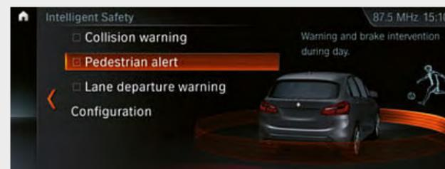
□ O assistente de condução Plus<sup>6,7</sup> oferece uma melhoria clara da segurança e do conforto. Inclui o aviso de colisão e reconhecimento de peões com ativação automática dos travões, o aviso de alteração de trajetória, o assistente das luzes de máximos, o aviso de limite de velocidade, o Cruise Control baseado em câmara com função Stop and Go, bem como o sistema de assistência em trânsito.
