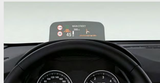
□ O BMW Head-Up Display Full-Colour projeta todas as informações de condução relevantes num painel no campo de visão do condutor, permitindo-lhe manter a atenção na estrada. São apresentados, entre outros elementos, a velocidade atual, indicações do sistema de navegação, aviso de limite de velocidade incluindo aviso de proibição de ultrapassagem e listas telefónicas e de entretenimento.
