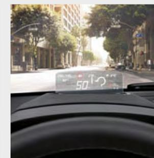
○ O BMW Head-Up Display projeta a informação do veículo e, em combinação com uma interface de Smartphone, a informação de navegação no campo de visão do condutor.
