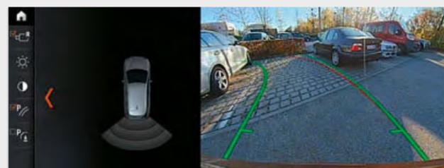
□ A câmara traseira permite uma melhor orientação ao realizar marcha-atrás a velocidades inferiores a 15 km/h, por exemplo, ao estacionar. Apresenta a área atrás do veículo no visor de controlos. Linhas de orientação interativas para medição da distância e do diâmetro de viragem oferecem suporte durante as manobras de marcha-atrás. Os obstáculos são assinalados a cores.
