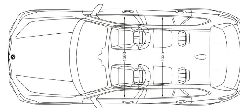
Todas as dimensões dos desenhos técnicos estão em milímetros. A altura sem a antena de tejadilho é de 1466 mm. Largura da via dianteira do BMW X5 M50d: 1684 mm, atrás: 1689 mm. Os valores da performance, consumo de combustível e emissões de CO<sub>2</sub> referem-se a veículos com transmissão de série.
