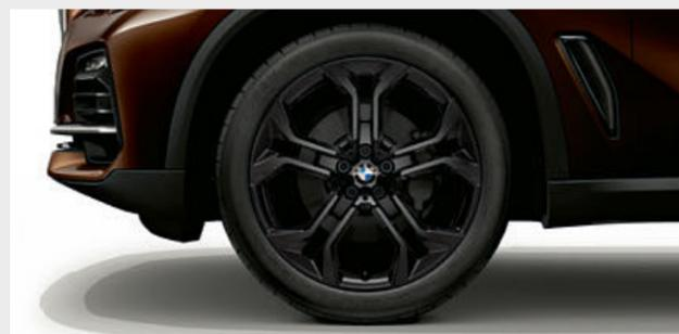
□ Jantes de liga leve BMW 744 de raios em Y de 21", em cinza Orbit com pneus mistos Runflat, jantes 9,5 J x 21 com pneus 275/40 R 21 à frente, jantes 10,5 J x 21 com pneus 315/35 R 21 atrás.<sup>1</sup>
