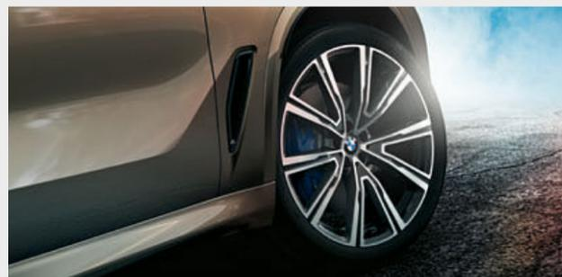
□ Jantes de liga leve BMW Individual 746 I de raios em V de 22", em cinza Orbit, polidas, com pneus mistos, jantes 9,5 J x 22 com pneus 275/35 R 22 à frente, jantes 10,5 J x 22 com pneus 315/30 R 22 atrás.
