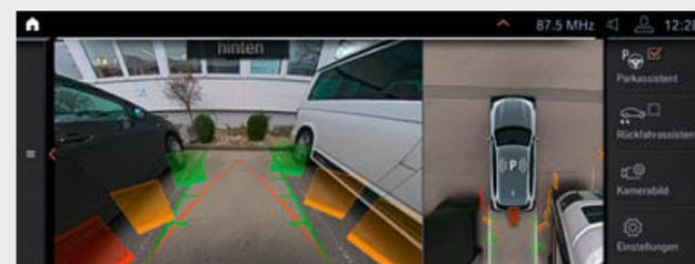
■ O assistente de estacionamento facilita o estacionamento do veículo. A câmara traseira oferece uma vista clara da retaguarda do veículo. O assistente de estacionamento permite estacionar o veículo de forma totalmente automática, quer seja paralelo ou perpendicular à rua, e permite também sair automaticamente de lugares de estacionamento paralelos à rua. O assistente de marcha-atrás auxilia o condutor a realizar a marcha-atrás, por exemplo, em ruas estreitas.
