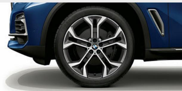
□ Jantes de liga leve BMW 744 de raios em Y de 21", em cinza Orbit de duas tonalidades, polidas, com pneus mistos Runflat, jantes 9,5 J x 21 com pneus 275/40 R 21 à frente, jantes 10,5 J x 21 com pneus 315/35 R 21 atrás.<sup>1</sup>
