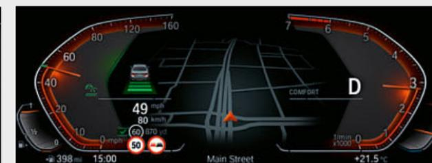
□ O assistente de limite de velocidade automático<sup>6</sup> adapta o Cruise Control ativo dinamicamente em relação aos limites de velocidade definidos. Estes são determinados ao longo do percurso provável através do sistema de navegação e são confirmados pela câmara. A informação prestada é continuamente atualizada por toda a frota.
