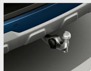
□ O dispositivo de acoplamento de reboque com esfera de acoplamento de ajuste elétrico e controlo de estabilidade do reboque está aprovado para cargas pesadas de até 3500 kg.
