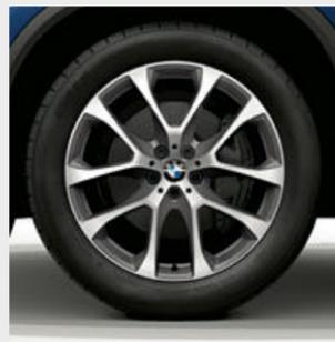
□ Jantes de liga leve BMW 738 de raios em V de 20", de duas tonalidades, polidas, com pneus mistos Runflat, jantes 9 J x 20 com pneus 275/45 R 20 à frente, jantes 10,5 J x 20 com pneus 305/40 R 20 atrás.<sup>2</sup>
