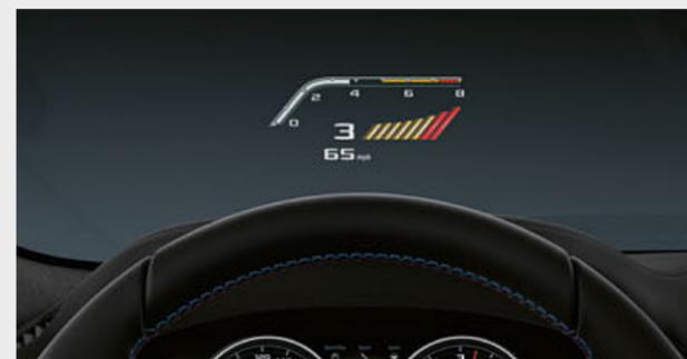
■ O BMW Head-Up Display Full-Colour<sup>1</sup> com funções específicas M projeta toda a informação relevante para a viagem diretamente no campo de visão do condutor. Ao toque num botão, o condutor pode mudar para o visor específico M, que inclui o indicador da velocidade atual, as rpm representadas em curva dinâmica com luzes de aviso do ponto ideal de mudança de velocidade, bem como sugestões de navegação.
