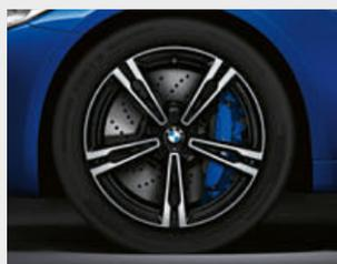
■ Jantes de liga leve BMW 705 M de raios duplos de 19" em cinza Orbit, polidas, com pneus mistos, 9,5 J x 19 com pneus 275/40 R 19 à frente; 10,5 J x 19 com pneus 285/40 R 19 atrás.
