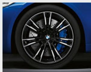
□ Jantes de liga leve BMW 706 M de raios duplos de 20" em preto, polidas, com pneus mistos, 9,5 J x 20 com pneus 275/35 R 20 à frente; 10,5 J x 20 com pneus 285/35 R 20 atrás.<sup>5</sup>
