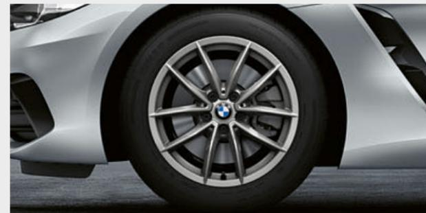
○ Jantes de liga leve BMW 768 de raios em V de 17" de elevada qualidade, disponíveis em cinza Ferric com pneus mistos Runflat. Conjunto de rodas completas de inverno TPMS, jantes 7,5 J x 17 com pneus 225/50 R 17 à frente, 8 J x 17 com pneus 225/50 R 17 atrás.
