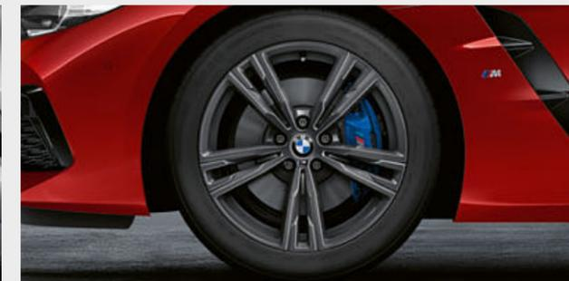
○ Jantes de liga leve BMW 798 M de raios duplos de 18" de elevada qualidade, disponíveis em cinza Orbit com pneus mistos. Conjunto de rodas completas de inverno TPMS, jantes 8,5 J x 18 com pneus 255/40 R 18 à frente, 9 J x 18 com pneus 255/40 R 18 atrás.
