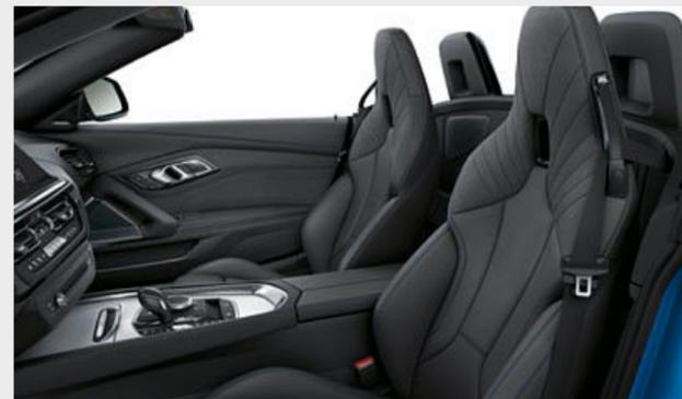
□ Os bancos desportivos M<sup>2,4</sup> com apoios de cabeça integrados, assentos envolventes elevados e apoios laterais do encosto oferecem ao condutor e ao passageiro da frente um apoio lateral excelente. Adicionalmente, os bancos podem ser ajustados à dimensão individual do corpo graças ao ajuste da largura do encosto integrado.
