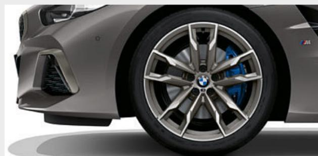
□ Jantes de liga leve BMW 800 M de raios duplos de 19" em cinza Cerium mate de duas tonalidades, polidas, com pneus mistos, jantes 9 J x 19 com pneus 255/35 ZR 19 à frente, jantes 10 J x 19 com pneus 275/35 ZR 19 atrás.
