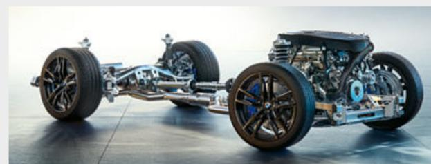
□ A suspensão adaptativa M<sup>2</sup> pode ser ajustada eletricamente em qualquer momento para se adequar ao piso e às condições de condução. Os condutores podem também ajustar as características da suspensão através do botão experiência de condução para selecionar o estilo de condução preferido – confortável ou extremamente desportivo, com um comportamento em estrada marcadamente mais ágil.
