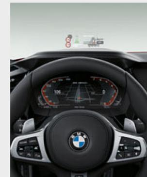
□ O BMW Head-Up Display<sup>7</sup> Full-Colour projeta informação relevante para a viagem diretamente no campo de visão do condutor.
