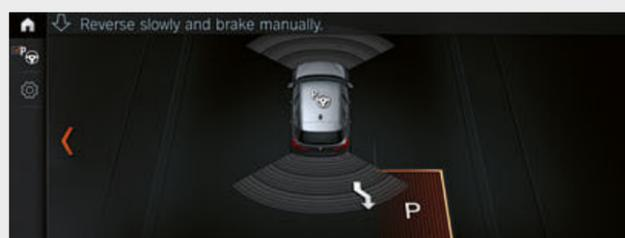
□ O assistente de estacionamento<sup>4</sup>\* facilita o estacionamento em paralelo. O sistema funciona através da medição de possíveis espaços de estacionamento quando passa por estes a baixa velocidade. Quando é detetado um espaço adequado, o assistente de estacionamento assume a direção, enquanto o condutor fica responsável por selecionar a mudança correta, assim como por acelerar ou travar conforme necessário.
