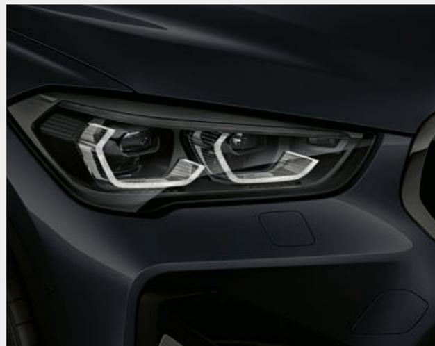
□ As luzes adaptativas LED incluem as luzes de médios, as luzes de máximos antiencandeamento (BMW Selective Beam) e os indicadores de mudança de direção com tecnologia LED. O equipamento integra ainda a iluminação em curva, as luzes de condução diurna e a distribuição adaptativa da luz para uma iluminação da estrada adaptada à situação de condução.
