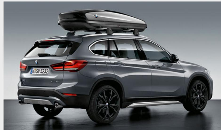
○ A moderna bagageira de tejadilho em preto com frisos laterais em prata Titanium oferece um volume de 520 litros e adapta-se a todos os sistemas de suporte de tejadilho BMW. Dispõe de um sistema de abertura de ambos os lados e fechadura tripla de comando central de cada lado, o que facilita as cargas e oferece proteção antirroubo.
