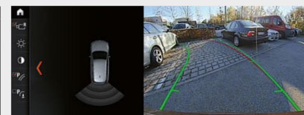
□ A câmara traseira\* permite uma melhor orientação ao realizar marcha-atrás a velocidades inferiores a 15 km/h, por exemplo, ao estacionar. Apresenta a área atrás do veículo no visor de controlos. As linhas de orientação interativas para medição da distância e do diâmetro de viragem oferecem suporte durante as manobras. Os obstáculos são assinalados a cores.
