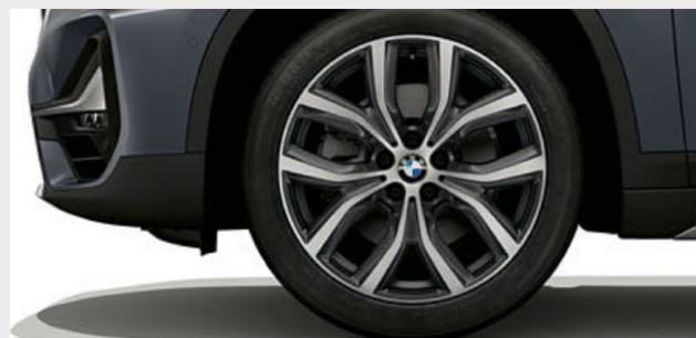
□ Jantes de liga leve BMW 511 de raios em Y de 19" em cinza Orbit, polidas, com pneus Runflat, 8 J x 19 com pneus 225/45 R 19.
