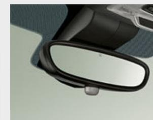
□ Espelho retrovisor interior e espelho retrovisor exterior do condutor com função automática antiencandeamento, incluindo função de rebatimento para os espelhos exteriores e função de estacionamento automática para o espelho do passageiro da frente.
