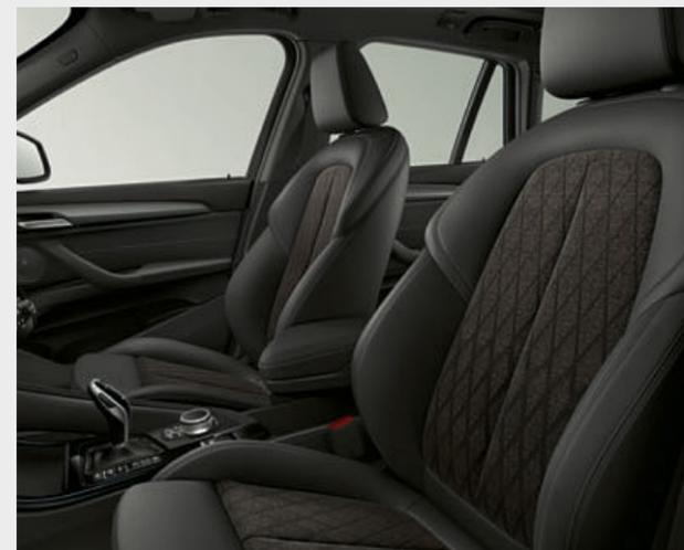
□ Os bancos desportivos para o condutor e para o passageiro da frente dispõem de ajuste elétrico da largura do encosto para o banco do condutor e ajuste mecânico da profundidade do assento. Os apoios laterais do encosto e do assento são maiores do que os dos bancos de série e, juntamente com o apoio femoral ajustável, oferecem excelente ergonomia e um melhor apoio lateral em curvas apertadas.
