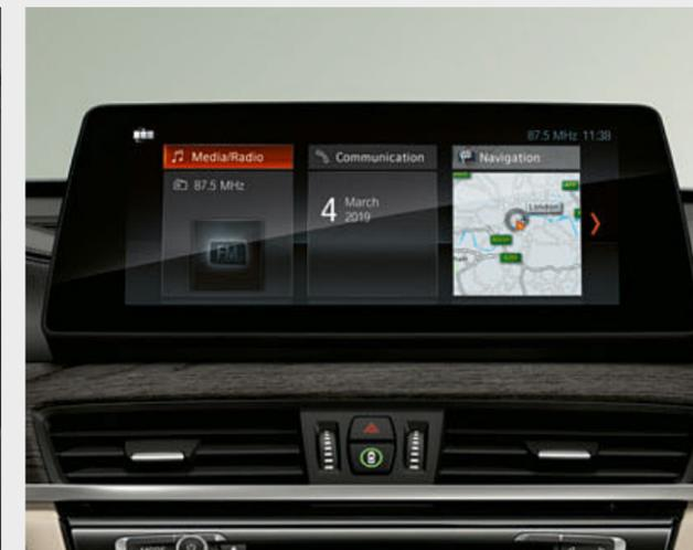
□ O sistema de navegação Plus inclui um BMW Head-Up Display, um controlador iDrive Touch, um ecrã LCD de 8,8" integrado e um painel de instrumentos com um ecrã TFT de 5,7" de alta resolução. O sistema é utilizado de forma intuitiva através do controlador iDrive Touch, dos botões de controlo direto do menu e de oito marcadores funcionais, do controlo por voz ou do ecrã tátil com mosaicos interativos.
