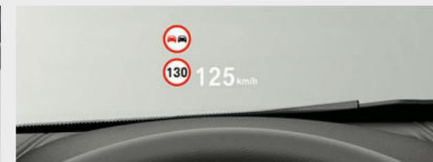
□ O BMW Head-Up Display Full-Colour<sup>2</sup> projeta informação relevante para a viagem diretamente no campo de visão do condutor, permitindo, deste modo, que o condutor se concentre apenas na condução. O visor inclui informação como a velocidade atual, indicações de navegação, aviso de limite de velocidade incluindo aviso de proibição de ultrapassagem, juntamente com listas telefónicas e de entretenimento.
