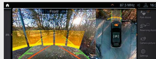
□ O assistente de estacionamento Plus<sup>1</sup> facilita o estacionamento e outras manobras com o veículo. Inclui, entre outros, o sistema Surround View com Top View, vista panorâmica, Remote 3D View, assim como a assistência ao estacionamento lateral, sensores de estacionamento ativos, função de travagem de emergência, o assistente de estacionamento com orientação linear e o assistente de marcha-atrás.
