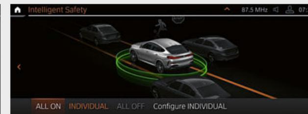
□ O assistente de condução Profissional<sup>5</sup>\* oferece conforto otimizado e segurança máxima em situações de trânsito críticas ou monótonas. Inclui: o assistente de direção e de faixa de rodagem com assistente de condução em estradas estreitas, o assistente de alteração de faixa de rodagem, o assistente de paragem de emergência, o aviso de perigo local, o assistente de alteração de trajetória com proteção ativa contra colisões laterais e outras funções de segurança.
