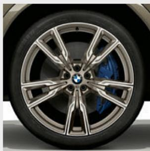
□ Jantes de liga leve BMW 747 M de raios em V de 22" em cinza Cerium mate, polidas, com pneus mistos, 9,5 J x 22 com pneus 275/35 R 22 à frente, 10,5 J x 22 com pneus 315/30 R 22 atrás.<sup>5</sup>
