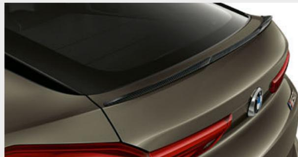
□ O spoiler traseiro M em carbono\* realça o impressionante design desportivo do automóvel e reduz consideravelmente as indesejadas forças de elevação no eixo traseiro.
