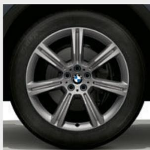
□ Jantes de liga leve BMW 736 de raios em estrela de 20" em cinza Ferric com pneus mistos Runflat\*, 9 J x 20 com pneus 275/45 R 20 à frente, 10,5 J x 20 com pneus 305/40 R 20 atrás.
