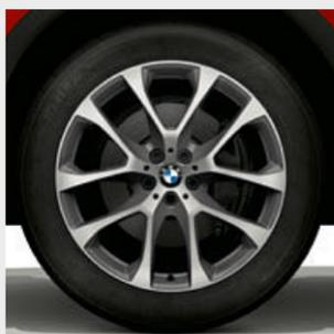
■ Jantes de liga leve BMW 738 de raios em V de 20" em cinza Ferric de duas tonalidades, polidas, com pneus mistos Runflat\*, 9 J x 20 com pneus 275/45 R 20 à frente, 10,5 J x 20 com pneus 305/40 R 20 atrás.<sup>1</sup>
