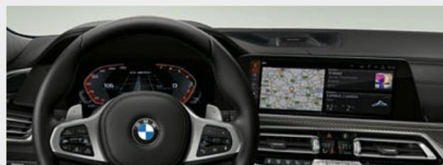
■ O BMW Live Cockpit Professional com função de navegação<sup>3</sup> inclui uma rede de visualização com dois visores de elevada qualidade: um visor de controlos de alta resolução de 12,3" que pode ser utilizado de forma tátil, e um painel de instrumentos com um visor de 12,3" totalmente digital.
