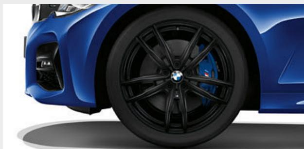
□ Jantes de liga leve BMW 791 M de raios duplos de 19", em preto Jet, polidas, com pneus mistos Runflat, jantes 8 J x 19 com pneus 225/40 R 19 à frente, jantes 8,5 J x 20 com pneus 255/35 R 19 atrás.<sup>2</sup>
