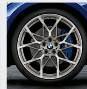
○ Jantes de liga leve BMW M Performance 795 de raios em Y de 20" em cinza Ferric mate de duas tonalidades, forjadas, fresadas, polidas. Conjunto de jantes completas de verão TPMS com pneus Runflat.
