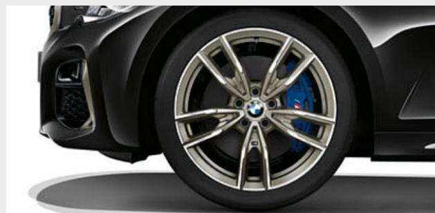
□ Jantes de liga leve BMW 792 M de raios duplos de 19", em cinza Cerium de duas tonalidades, polidas, com pneus mistos Runflat, jantes 8 J x 19 com pneus 225/40 R 19 à frente, jantes 8,5 J x 20 com pneus 255/35 R 19 atrás.<sup>1\*</sup>
