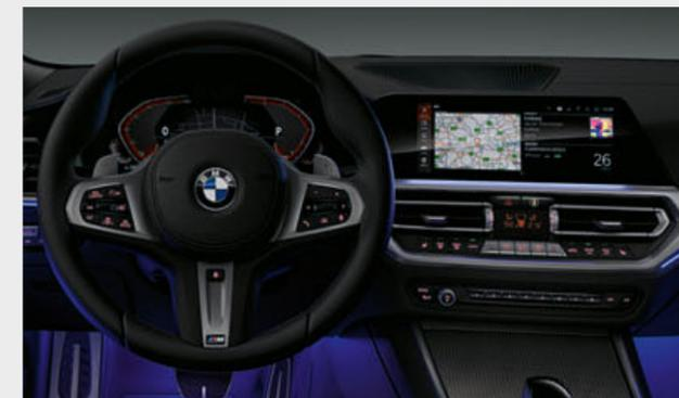
□ O BMW Live Cockpit Professional\* com função de navegação inclui uma rede de visualização com dois visores de elevada qualidade: um visor de controlos de alta resolução de 10,25" que pode ser utilizado de forma tátil, e um painel de instrumentos com um visor de 12,3" totalmente digital. O sistema operativo BMW 7.0 pode também ser utilizado através do controlador iDrive Touch.
