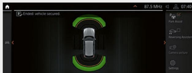
□ O assistente de estacionamento Plus\* facilita o estacionamento e outras manobras com o veículo. Inclui, entre outros, o sistema Surround View com Top View, vista panorâmica, Remote 3D View, assim como a assistência ao estacionamento lateral, a função de travagem de emergência, os sensores de estacionamento ativos, o assistente de estacionamento com orientação linear e o assistente de marcha-atrás.
