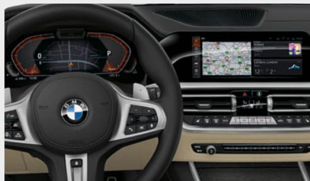
□ O BMW Live Cockpit Professional\* com função de navegação inclui uma rede de visualização de alta qualidade composta por um visor de controlos de alta resolução de 10,25" que pode ser utilizado de forma tátil, e um painel de instrumentos totalmente digital de 12,3". O sistema operativo BMW 7.0 pode também ser utilizado através do controlador do iDrive.
