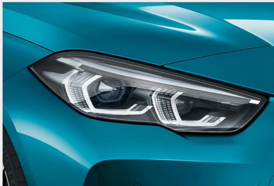
□ As luzes adaptativas LED de série incluem as luzes de médios, as luzes de máximos antiencandeamento (BMW Selective Beam) assim como os indicadores de mudança de direção com tecnologia totalmente LED. O equipamento integra ainda a iluminação em curva, as luzes de condução diurna e as luzes adaptativas com distribuição variável da luz para condução urbana, extra-urbana ou em autoestrada, para uma iluminação excelente da estrada.
