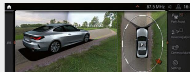
□ O Surround View\* inclui as funções Top View, vista panorâmica e vista 3D, baseadas em câmaras. As câmaras na dianteira, na traseira e nos espelhos retrovisores exteriores permitem a apresentação de uma vista 360°, bem como de uma vista panorâmica, no visor de controlos. A vista panorâmica facilita a aproximação aos cruzamentos e aos acessos com fraca visibilidade.
