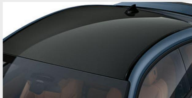
□ Incluído no conceito de construção inteligente de baixo peso, o tejadilho M em fibra de carbono<sup>1</sup> ajuda a reduzir o peso do veículo. O tejadilho é fabricado em plástico reforçado com fibra de carbono (CFRP) e é 7 kg mais leve do que um tejadilho comparável em aço disponível de série. Desta forma, o centro de gravidade do veículo é reduzido e a dinâmica de condução aumenta.
