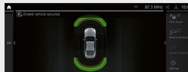
■ O assistente de estacionamento<sup>4</sup>\* estaciona o veículo de forma independente em lugares de estacionamento paralelos ou perpendiculares à estrada, retirando também o automóvel de forma independente de lugares de estacionamento paralelos à via. É ativado através do botão de estacionamento ou quando engrena a marcha-atrás. A direção, a condução e a travagem são assumidas pelo sistema, enquanto o condutor tem apenas de monitorizar o processo de estacionamento.
