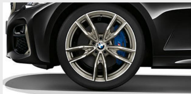
□ Jantes de liga leve BMW 792 M de raios duplos de 19" em cinza Cerium de duas tonalidades, polidas, com pneus mistos Runflat, 8 J x 19 com pneus 225/40 R 19 à frente, 8,5 J x 19 com pneus 255/35 R 19 atrás.<sup>3</sup>
