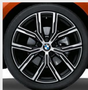
□ Jantes de liga leve BMW 783 de raios em Y de 19" em preto Jet de duas tonalidades, polidas, com pneus mistos Runflat, 8 J x 19 com pneus 225/40 R 19 à frente, 8,5 J x 19 com pneus 255/35 R 19 atrás.
