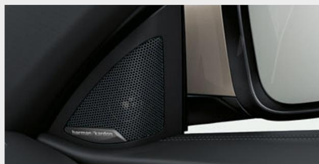
□ O extraordinário sistema de som surround Harman Kardon inclui um amplificador digital de 464 W, nove canais e 16 altifalantes. O som sofisticado preenche o interior de forma perfeita. Específica do veículo, a equalização indexada à velocidade compensa com precisão qualquer ruído de fundo durante a condução.
