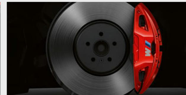
□ Os travões desportivos M têm pinças fixas de quatro êmbolos no eixo dianteiro e pinças flutuantes de um êmbolo no eixo traseiro em vermelho brilhante<sup>2</sup> com designação M e discos de travão de grandes dimensões de modo a garantir uma excelente performance de travagem. Adaptados ao potencial dinâmico extremamente elevado do veículo, permitem também um estilo de condução excepcionalmente desportivo e uma travagem excelente em pisos molhados.
