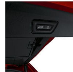
■ O funcionamento automático da porta da bagageira permite abrir e fechar a porta da bagageira através de um simples toque no botão relevante.
