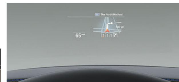
□ O amplo BMW Head-Up Display<sup>2</sup> Full-Colour projeta informações relevantes para a viagem diretamente no seu campo de visão, permitindo-lhe assim concentrar-se totalmente na condução. São apresentadas informações como a velocidade atual, indicações de navegação, o aviso de limite de velocidade incluindo o aviso de proibição de ultrapassagem, juntamente com listas telefónicas e do sistema de informação e lazer, dependendo do equipamento.
