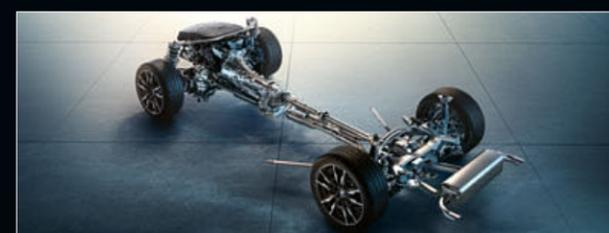
□ O diferencial desportivo M<sup>3</sup> otimiza a tração e a estabilidade de condução quando muda de faixa de rodagem ou acelera à saída de curva, quando descreve curvas a velocidades elevadas ou em diferentes pisos. A tração é otimizada com a ajuda de um dispositivo eletrónico que reduz a diferença de rotação entre as rodas traseiras.
