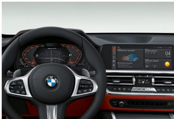
□ O BMW Live Cockpit Professional com função de navegação inclui uma rede de visualização com dois visores de elevada qualidade: um visor de controlos de alta resolução de 10,25" que pode ser utilizado de forma tátil, e um painel de instrumentos totalmente digital com um visor de 12,3". O sistema operativo BMW 7 pode também ser utilizado através do controlador iDrive Touch.
