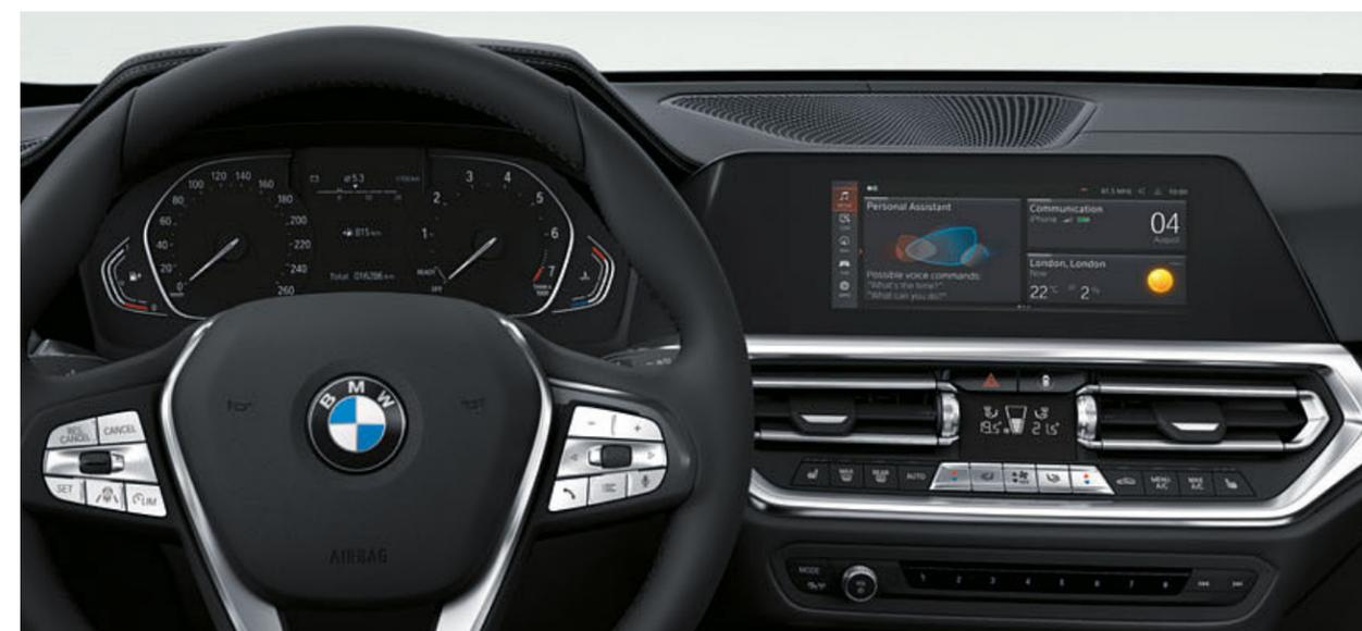
■ O BMW Live Cockpit Plus integra um painel de instrumentos com um visor de 5,1" e um visor de controlos de alta resolução de 8,8" com função tótil.
