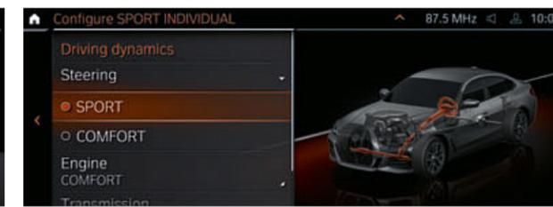
□ A direção desportiva variável<sup>2</sup> com Servotronic permite um comportamento em estrada mais direto e ágil e garante um menor esforço físico ao rodar o volante. Reage ao ângulo de viragem com diferentes relações de direção. Esta função permite melhorar o comportamento em estrada com uma condução mais dinâmica, reduzindo o esforço necessário ao rodar o volante durante o estacionamento e na descricção de curvas.
