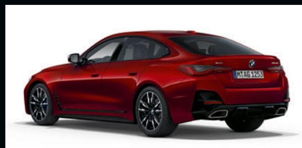
□ O pack exterior M em carbono<sup>1</sup> realça as ambições desportivas do automóvel. Os componentes laterais do spoiler no para-choques dianteiro e as capas dos espelhos retrovisores exteriores são fabricados em plástico reforçado com fibra de carbono (CFRP). O pack é completado pelos frisos laterais na traseira e pelo spoiler traseiro com geometria específica.
