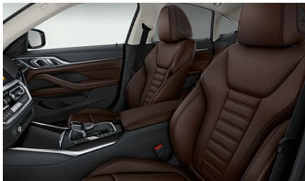
■ Os bancos desportivos para o condutor e para o passageiro da frente oferecem suporte lateral otimizado com os apoios laterais elevados e o apoio femoral ajustável manualmente. A posição longitudinal do banco, a altura do banco e o ângulo de inclinação do encosto podem ser ajustados manualmente.
