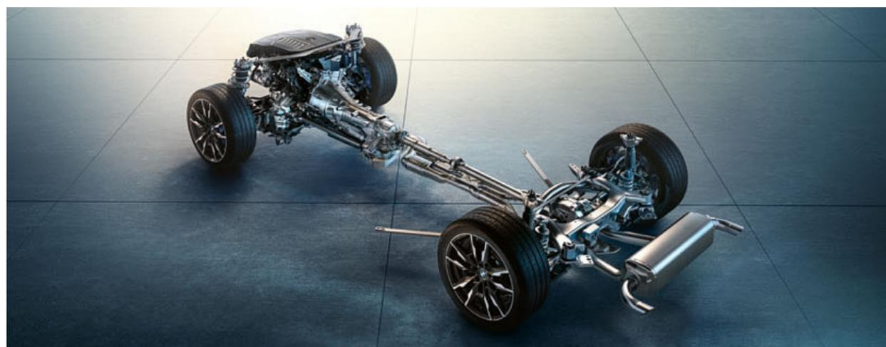
□ A suspensão adaptativa M pode ser ajustada eletricamente em qualquer momento para se adequar ao piso e às condições de condução. Os condutores podem também ajustar as características da suspensão através do botão experiência de condução para seleccionar o estilo de condução preferido – confortável ou extremamente desportivo, com um comportamento em estrada marcadamente mais ágil.
