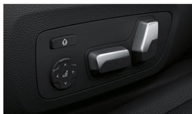
□ O ajuste elétrico dos bancos torna o ajuste dos bancos do condutor e do passageiro da frente especialmente cómodo e fácil. A função de memória permite ao condutor memorizar e recuperar as configurações preferenciais do banco do condutor e dos espelhos retrovisores exteriores com o simples toque num botão.
