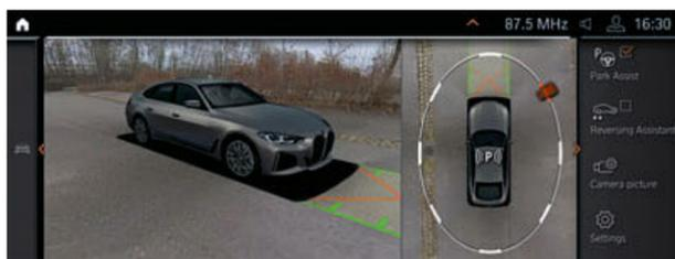
□ O assistente de estacionamento Plus<sup>1</sup> facilita o estacionamento e outras manobras com o veículo. Inclui, entre outros, o sistema Surround View com Top View, vista panorâmica, Remote 3D View, assim como a assistência ao estacionamento lateral, a função de travagem de emergência, os sensores de estacionamento ativos, o assistente de estacionamento com orientação longitudinal e lateral e o assistente de marcha-atrás.
