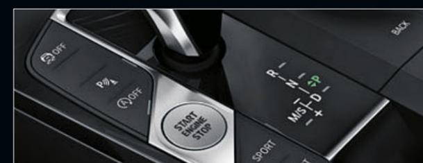
□ Um automóvel com um arranque em poucos segundos? Sem problema com o **sistema de controlo do arranque<sup>1</sup>** da transmissão desportiva de 8 velocidades Steptronic. Com a alavanca seletora na posição "S", pressione levemente o botão DSC e pressione totalmente o pedal do acelerador com o travão acionado. Liberte o pedal do travão para uma experiência de aceleração máxima do seu BMW no limite da tração e sinta a sua pulsação disparar simultaneamente.
