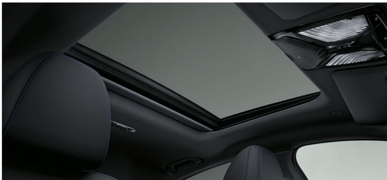
□ O teto de abrir em vidro com função de deslizamento e elevação, que inclui um teto interior deslizante, proteção antientalamento e a abertura/ fecho práticos, permite que o caudal de ar seja ajustado individualmente para que se crie um ambiente agradável no habitáculo. O defletor de vento integrado impede que as correntes de ar se desenvolvam no habitáculo, garantindo um nível mais baixo de ruído provocado pelo vento.
