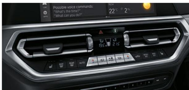
■ O ar condicionado automático com controlo de três zonas e controlo automático da temperatura apresenta controlos separados para o condutor e para o passageiro da frente, assim como para os passageiros nos bancos traseiros. Inclui ainda a recirculação automática do ar (AAR), um microfiltro de carvão ativo, um sensor de embaciamento e de luz solar, bem como ventiladores na parte traseira do habitáculo com visor digital.
