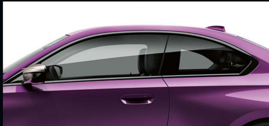
□ Os frisos exteriores M Shadow Line<sup>1,2</sup>, brilhante, incluem diversos detalhes do equipamento em preto brilhante. Estes incluem o revestimento dos caixilhos dos vidros, os caixilhos dos vidros, o aro, o triângulo e a pala dos espelhos retrovisores exteriores.
