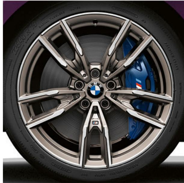
■ Jantes de liga leve BMW 792 M de raios duplos de 19" em cinza Cerium mate de duas tonalidades, polidas, com pneus mistos, 8 J x 19 com pneus 225/40 R 19 à frente, 8,5 J x 19 com pneus 255/35 R 19 atrás.<sup>2,4</sup>
