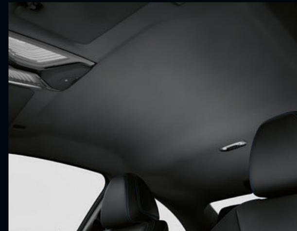
□ Forro do teto M em Antracite<sup>2</sup>: o forro do teto, cobertura da bagageira e os frisos dos pilares do veículo são em tecido em Antracite.
