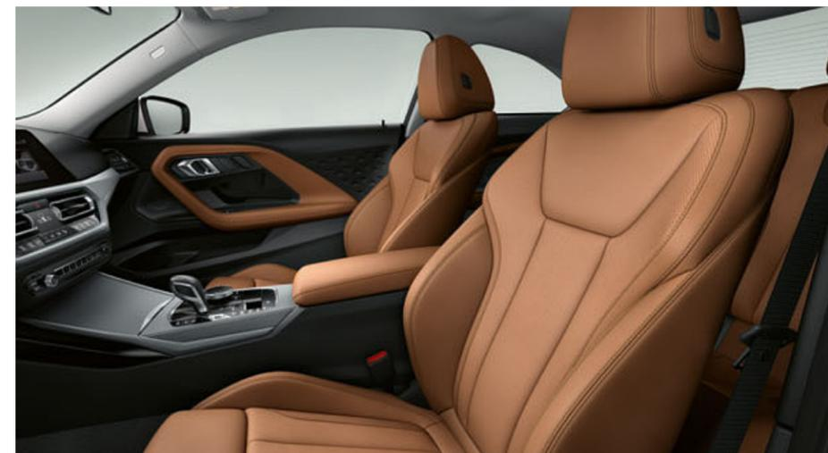
■ Os bancos desportivos para o condutor e para o passageiro da frente oferecem suporte lateral otimizado com os apoios laterais elevados e o apoio femoral ajustável manualmente. A posição longitudinal do banco, a inclinação do banco e o ângulo de inclinação do encosto podem ser ajustados manualmente.
