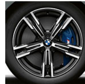
■ Jantes de liga leve BMW 848 M de raios duplos de 18" em preto Jet de duas tonalidades, polidas, com pneus mistos, 7,5 J x 18 com pneus 225/45 R 18 à frente, 8,5 J x 18 com pneus 255/40 R 18 atrás.
