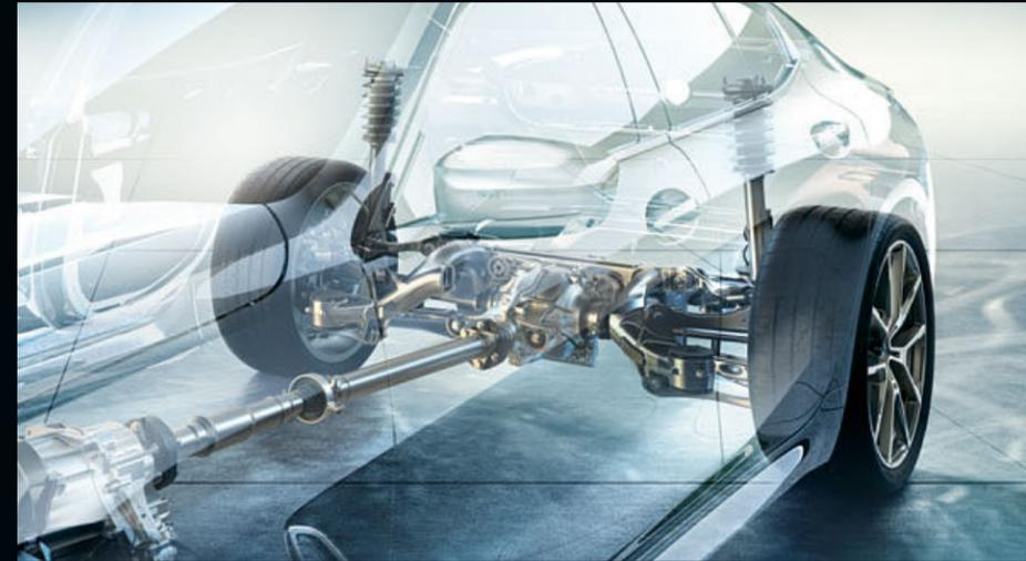
■ O diferencial desportivo M<sup>1,2</sup> otimiza a tração e a estabilidade de condução quando muda de faixa de rodagem ou acelera à saída de curva, quando descreve curvas a velocidades elevadas ou em diferentes pisos. A tração é otimizada com a ajuda de um dispositivo eletrónico que reduz a diferença de rotação entre as rodas traseiras.
