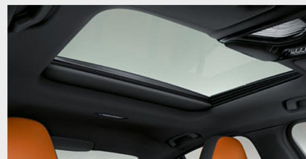
□ O teto de abrir em vidro com função de deslizamento e elevação, que inclui um teto interior deslizante, proteção antientalamento e a abertura/fecho práticos, permite que o caudal de ar seja ajustado individualmente para que se crie um ambiente agradável no habitáculo. O defletor de vento integrado impede que as correntes de ar se desenvolvam no habitáculo, garantindo um nível mais baixo de ruído provocado pelo vento.
