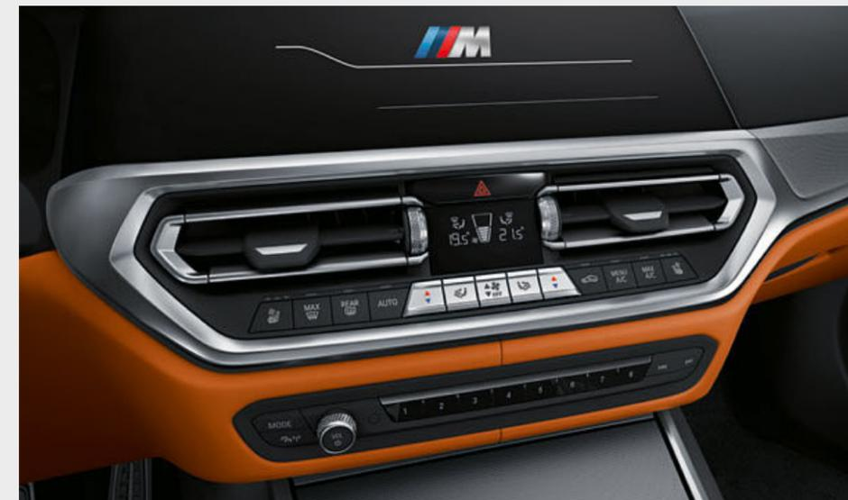
■ O ar condicionado automático com controlo de três zonas e controlo automático da temperatura apresenta controlos separados para o condutor e para o passageiro da frente, assim como para os passageiros nos bancos traseiros. Inclui ainda a recirculação automática do ar (AAR), um microfiltro de carvão ativo, um sensor de embaciamento e de luz solar, bem como ventiladores na parte traseira do habitáculo com visor digital.
