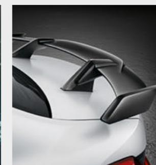
o O spoiler traseiro M Performance com perfil aerodinâmico é fabricado 100% em fibra de carbono de alta qualidade e cria um visual marcadamente automobilístico na traseira do veículo.
