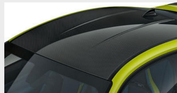
■ Como parte do conceito de construção inteligente de baixo peso da BMW, o tejadilho fabricado em plástico reforçado com fibra de carbono<sup>4</sup> (CFRP) ajuda a reduzir o peso do veículo e baixa o centro de gravidade do veículo. Isto conduz a um aumento na agilidade e na dinâmica ao curvar, acelerar e travar.
