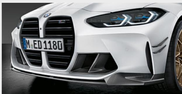
o Destaca-se: o spoiler dianteiro M Performance fabricado a 100% em fibra de carbono destaca a aparência desportiva do veículo de forma bastante exclusiva. Uma aparência de automobilismo única para todos os que se recusam a fazer compromissos.
