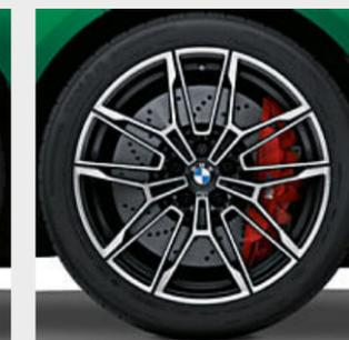
□ Jantes de liga leve BMW 825 M de raios duplos de 19"/20" forjadas, em preto de duas tonalidades, polidas/fresadas, com pneus mistos, 9,5 J x 19 com pneus 275/35 R 19 à frente, 10,5 J x 20 com pneus 285/30 R 20 atrás.
