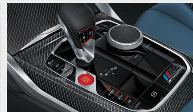
□ A configuração M permite-lhe configurar diversos parâmetros de dinâmica de condução como, por exemplo, as características do motor, da transmissão e da direção, as definições dos amortecedores, a intensidade de controlo do controlo dinâmico de estabilidade (DSC) ou a distribuição da potência do sistema de tração integral M xDrive de acordo com os seus requisitos pessoais.
