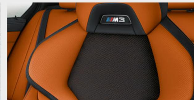
□ Em condições atmosféricas quentes, a ventilação ativa dos bancos dianteiros oferece um maior conforto dos bancos. As ventoinhas nos encostos dos bancos e as ventoinhas nos assentos retiram o ar interior, a uma intensidade selecionada, através dos estofos com perfuração fina e garantem uma temperatura agradável nos bancos do condutor e do passageiro da frente.<sup>4</sup>
