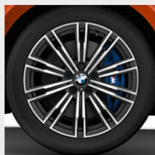
■ Jantes de liga leve BMW 790 M de raios duplos de 18" em cinza Orbit de duas tonalidades, polidas, com pneus mistos, jantes 7,5 J x 18 com pneus 225/45 R 18 à frente, jantes 8,5 J x 18 com pneus 255/40 R 18 atrás.
