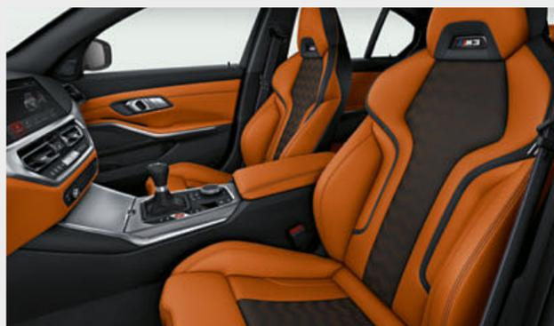
■ Os bancos desportivos M com múltiplos ajustes e encostos de cabeça parcialmente integrados oferecem um apoio lateral excelente ao condutor e ao passageiro da frente. Além disso, a largura dos encostos dos bancos pode ser ajustada individualmente. O design especial com o logótipo M4 iluminado realça as capacidades desportivas do automóvel.
