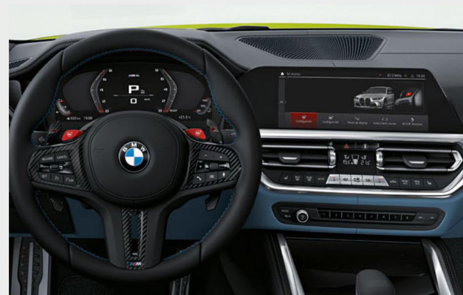
■ O BMW Live Cockpit Professional com função de navegação inclui uma rede de visualização com dois visores de elevada qualidade: um visor de controlos de alta resolução de 10,25" que pode ser utilizado de forma tátil, e um painel de instrumentos totalmente digital com um visor de 12,3". O sistema operativo BMW 7 pode também ser utilizado através do controlador iDrive Touch.
