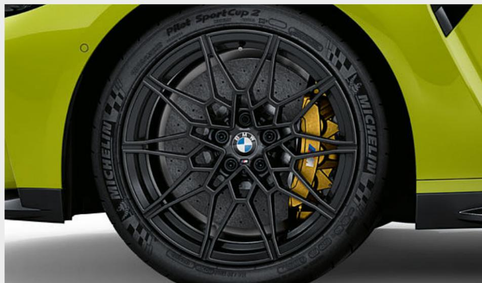
□ Jantes de liga leve BMW 826 M de raios duplos de 19"/20" forjadas, em preto, com pneus mistos e pneus de pista, 9,5 J x 19 com pneus 275/35 R 19 à frente, 10,5 J x 20 com pneus 285/30 R 20 atrás.<sup>1,2</sup>
