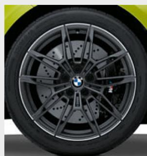
□ Jantes de liga leve BMW 825 M de raios duplos de 19"/20" forjadas, em cinza Orbit mate de duas tonalidades com aros polidos, com pneus mistos, 9,5 J x 19 com pneus 275/35 R 19 à frente, 10,5 J x 20 com pneus 285/30 R 20 atrás.
