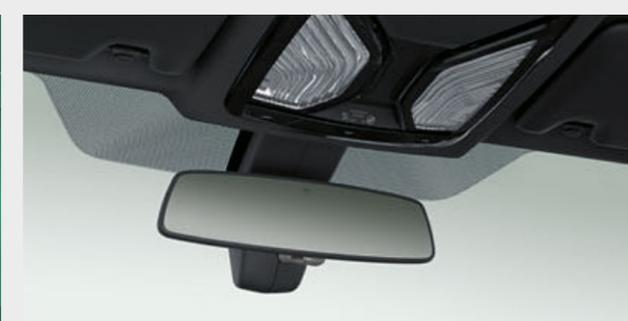
□ O espelho retrovisor interior e o espelho retrovisor exterior do lado do condutor têm função automática antiencandeamento. Além disso, o espelho retrovisor exterior do lado do passageiro da frente dispõe de função automática de estacionamento quando está engrenada a marcha-atrás. Ambos os espelhos retrovisores exteriores estão equipados com função de rebatimento elétrico, bem como com função de memória. Isto facilita o estacionamento e auxilia o condutor a evitar danos no automóvel.
