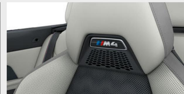
□ O sistema de aquecimento do pescoço garante conforto de condução proporcionado calor agradável para a cabeça e ombros. Quando a capota está aberta, o sistema de aquecimento integrado nos encostos de cabeça dos bancos dianteiros é ajustado automaticamente com base na velocidade e na temperatura exterior. Três níveis diferentes de temperatura podem ser selecionados individualmente.
