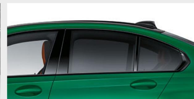
□ Os vidros com proteção solar impedem o aquecimento do interior durante a exposição direta aos raios solares. Os vidros mais escurecidos atrás dos pilares B absorvem mais luz solar. Os vidros escurecidos não afetam a visibilidade para o exterior e protegem os bancos traseiros dos olhares mais curiosos.
