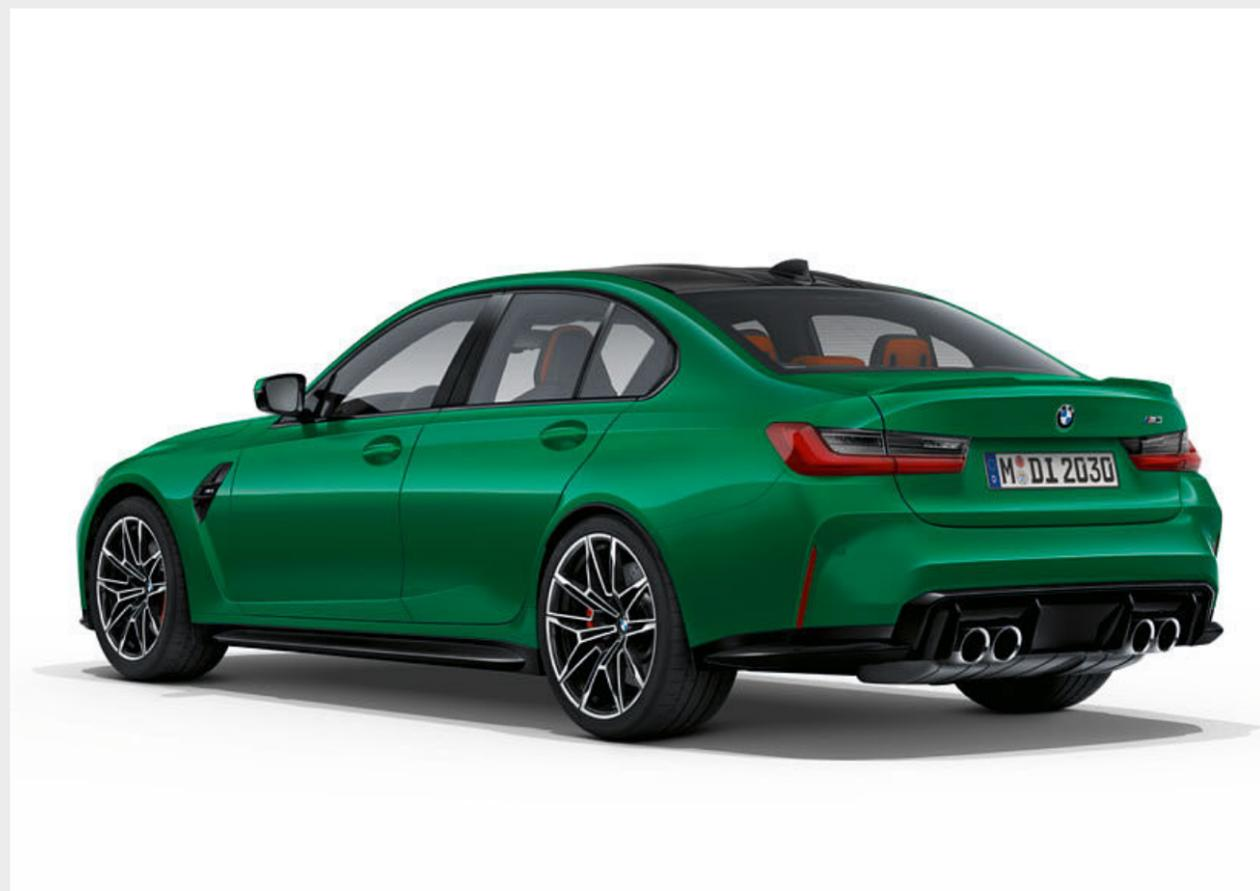
O tejadilho M em carbono destaca visualmente o design de automobilismo e, ao mesmo tempo, reduz o centro de gravidade. As antenas na extremidade do tejadilho e o spoiler traseiro M, discretamente pintado na cor da carroçaria, otimizam a aerodinâmica do novo BMW M3 Berlina. As ponteiras de escape duplas à esquerda e à direita em cromado brilhante e o difusor M extensivamente rebaixado são um testemunho da tecnologia de automobilismo e envolvem visualmente a traseira de forma descendente.
