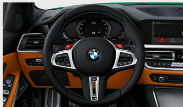
■ O volante M em pele com perfil vincado para os polegares proporciona uma experiência da direção direta e desportiva e o máximo controlo. Os botões multifunções integrados permitem a utilização de diversos sistemas multimédia e de assistência. Os botões M1/M2 vermelhos podem ser utilizados para aceder a duas configurações M Drive predefinidas.
