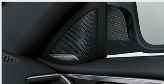
□ O extraordinário sistema de som surround Harman Kardon inclui um amplificador digital de 408 W, nove canais e 12 altifalantes. O som sofisticado preenche o interior de forma perfeita. Específica do veículo, a equalização indexada à velocidade compensa com precisão qualquer ruído de fundo durante a condução.
