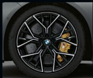
□ Jantes de liga leve BMW 811 M de raios em estrela de 20" em preto Jet de duas tonalidades, polidas, com pneus mistos, 9,5 J x 20 com pneus 275/35 R 20 à frente; 10,5 J x 20 com pneus 285/35 R 20 atrás.
