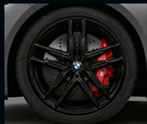
□ Jantes de liga leve BMW 810 M de raios duplos de 20" em preto Jet com pneus mistos, 9,5 J x 20 com pneus 275/35 R 20 à frente; 10,5 J x 20 com pneus 285/35 R 20 atrás.
