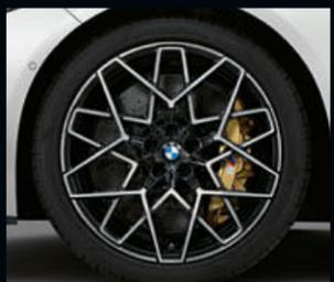
□ Jantes de liga leve BMW 813 M de raios em estrela de 20" em preto Jet de duas tonalidades, polidas, com pneus mistos, 9,5 J x 20 com pneus 275/35 R 20 à frente; 10,5 J x 20 com pneus 285/35 R 20 atrás.
