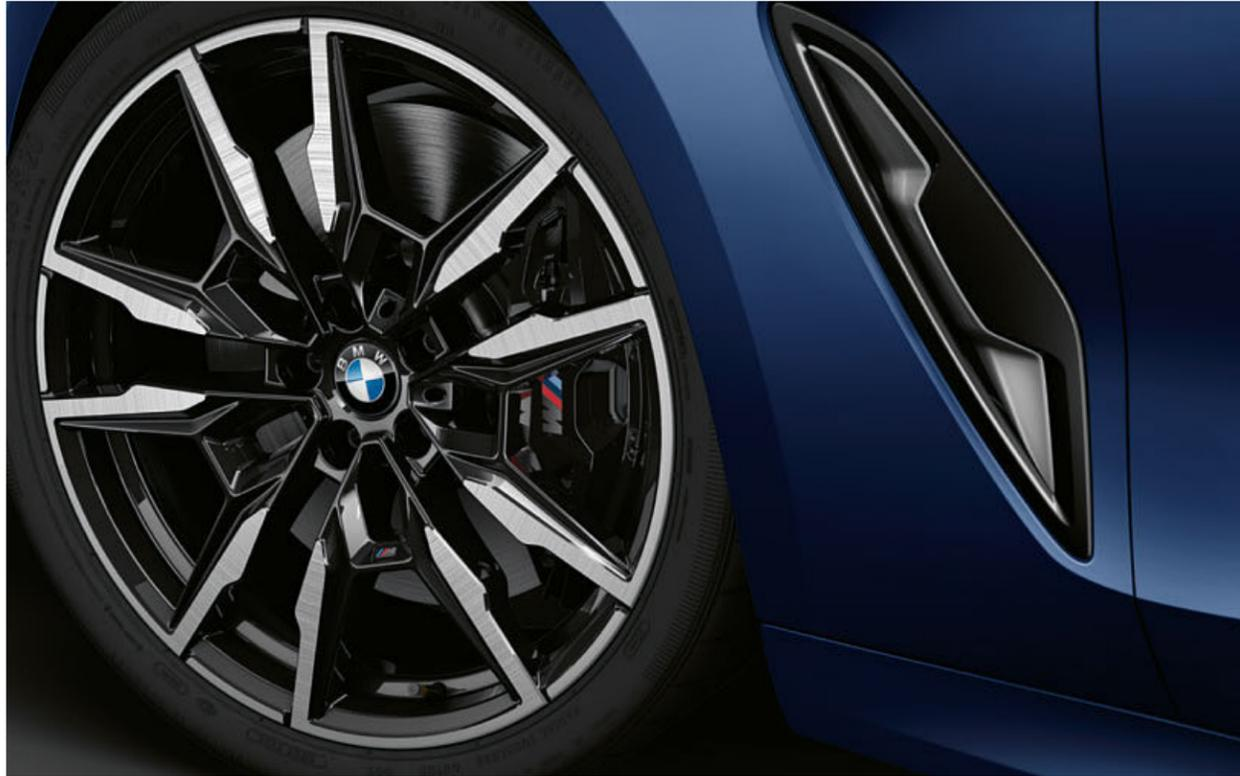
■ Jantes de liga leve BMW 895 M de raios duplos de 20" em preto Jet de duas tonalidades, polidas, com pneus mistos Performance, 8 J x 20 com pneus 245/35 R 20 à frente, 9 J x 20 com pneus 275/30 R 20 atrás.<sup>1</sup>
