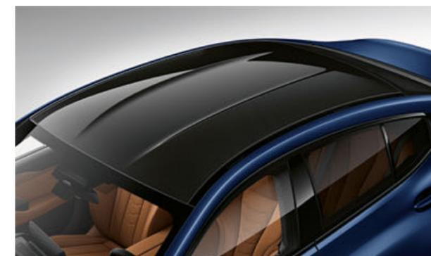
□ Incluído no conceito de construção inteligente de baixo peso, o tejadilho M em fibra de carbono<sup>2</sup> ajuda a reduzir o peso do veículo. O tejadilho é composto por plástico reforçado com fibra de carbono (CFRP) e é mais leve do que o tejadilho de série. Desta forma, o centro de gravidade do veículo diminui e a dinâmica de condução aumenta.
