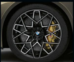
□ Jantes de liga leve BMW 813 M de raios em estrela de 20" em cinza Black de duas tonalidades, polidas, com pneus mistos, 9,5 J x 20 com pneus 275/35 R 20 à frente; 10,5 J x 20 com pneus 285/35 R 20 atrás.
